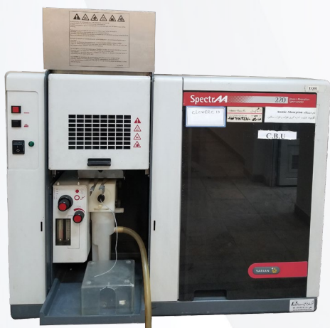
طیف‌سنج جذب اتمی مدل VARIAN جهت آنالیز فلزات به خصوص فلزات سنگین طیف‌سنجی جذب اتمی برای اندازه‌گیری کمی عناصر شیمیایی با استفاده از جذب اشعه نوری توسط اتم در حالت گازی است.
